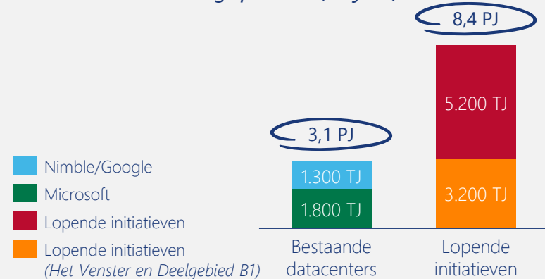
Geschatte restwarmtepotentieel datacenters Agriport A7 (PJ/jaar)
